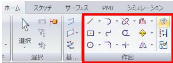
9.作図したスケッチ領域を選択してタブを作成します。
