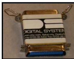
旧プロテクトユニット
